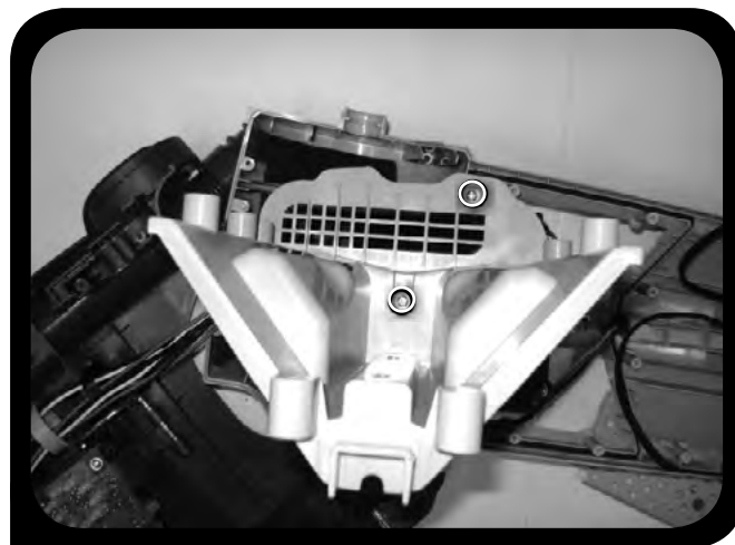
10. Retirer le séparateur d'air – extraire les deux vis (M4 x 20 mm de longueur)
